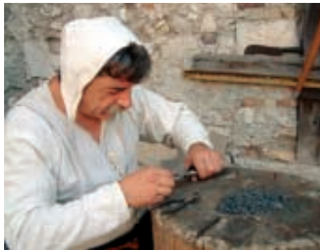
Kettenhemdproduktion auf Schloss Runkelstein: 300 Arbeitsstunden für 30.000 bis 40.000 Kettenringe
